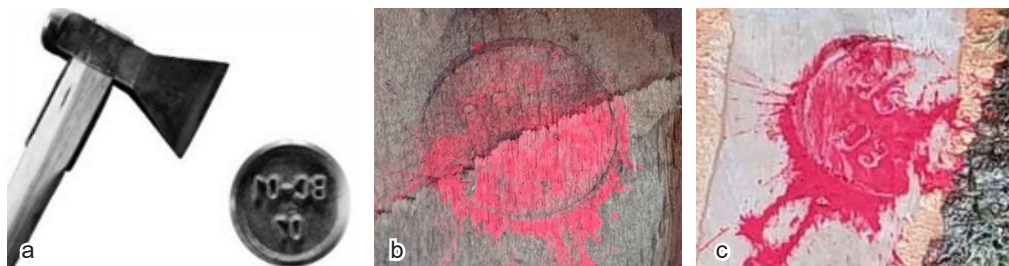
Figura 2 a) Dispozitiv de marcat cu amprentă rotundă; b), c) Amprentă cu vopsea roșie. a) Marking device with the round stamp; b), c) Stamp with red paint
