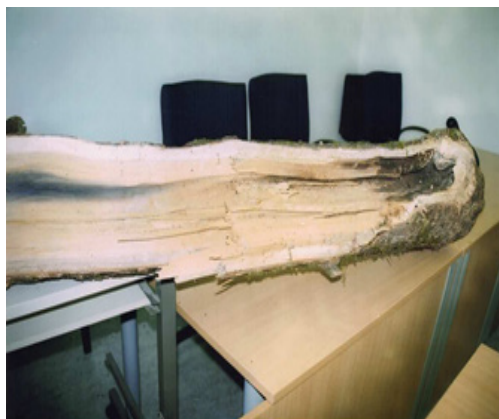
Figura 3 Aspectul unui segment al ramurii lungi și groase cedate, segment sechestrat imediat după accident de către organele de poliție care au investigat cazul și pus la dispoziția expertului de către tribunalul competent. În dreapta se vede umflătura la exterior și zona de putregai colorată în negru la interior. Restul segmentului arată zona de cedare prin forfecare (foto J. Femmig) The appearance of a segment of the long and thick broken branch, segment sequestered immediately after the accident by the police authorities who investigated the case and made available to the expert by the competent court. On the right you can see the swelling on the outside and the area of rot coloured black on the inside. The rest of the segment shows the zone of shear failure (photo J. Femmig)
