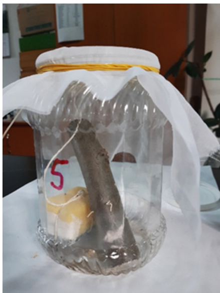
Figura 1 Borcan cu un segment de tulpină subțire de fag și buretele care a asigurat umiditatea necesară A jar with a segment of thin beech stem and a piece of sponge that provided the necessary humidity
