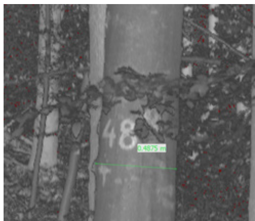
Figura 11 Diametrul la 1.3 m măsurat pe scanare DBH measured on scan
