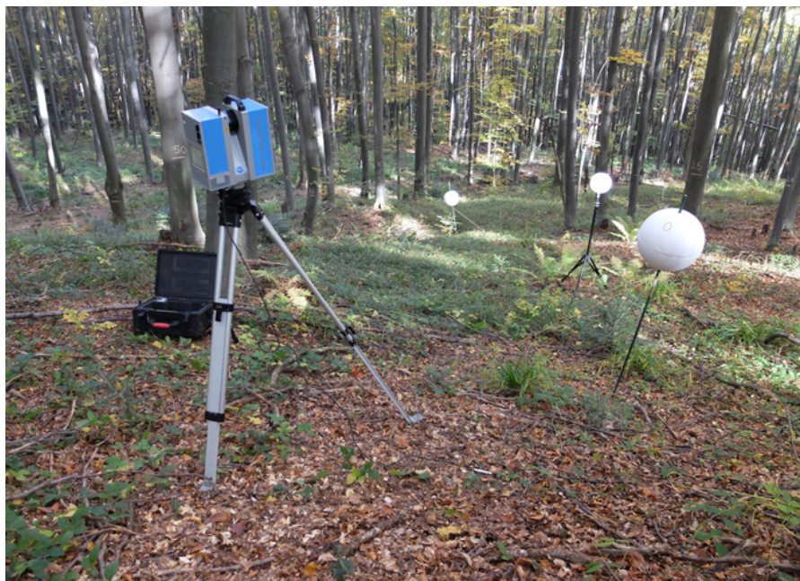
Figura 1 Aparatul scanner terestru laser (TLS) scanează o suprafață de probă. Reperele sferice sunt folosite pentru a fuziona mai multe scanări și a crea un nor de puncte 3D cât mai complet (Foto: O. Bouriaud) TLS scanning a plot. Spheric targets are used for coregistration to create a 3D point cloud
