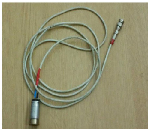
Figura 2 Traductorul și sonda de transmitere a semnalului la osciloscop The transducer and the probe transmitting signal to oscilloscope
