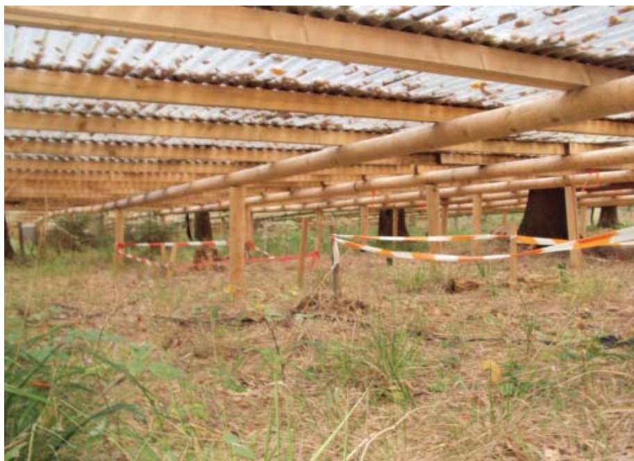
Suprafață de probă total acoperită din cadrul experimentului referitor la susceptibilitatea arborilor de molid la atacul gândacilor de scoarță în condiții de secetă (Foto: Ecaterina Mateiciuc)
