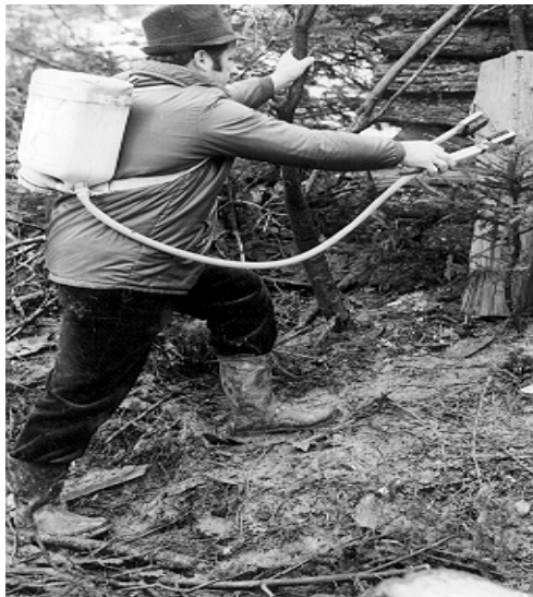
Aparatul IDEAL : materialul se poartă într-un bidon pe spate, ceea ce ușurează deplasarea pe teren
